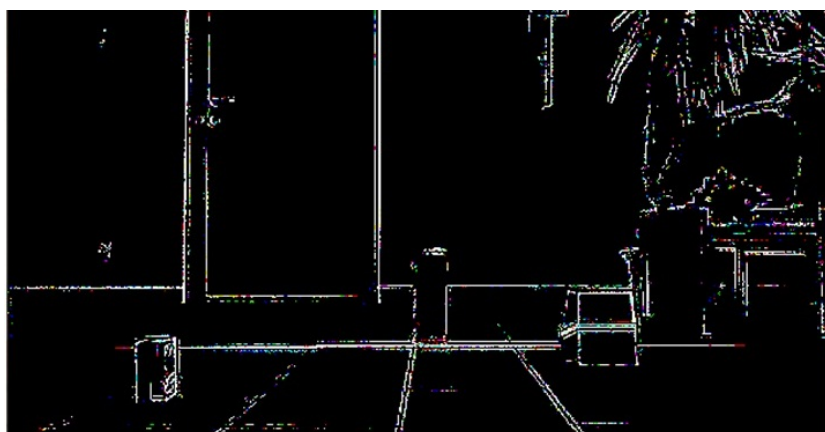
2.5. ábra. A LoG éldetektálás eredménye (küszöbérték: 150)
