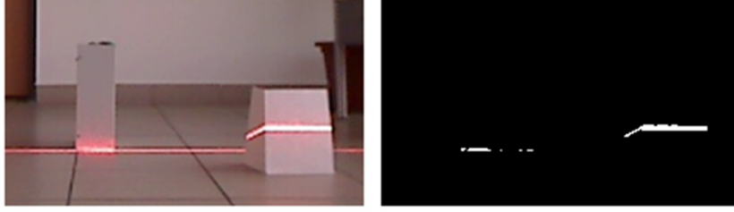
2.3. ábra. Intenzitás alapú lézertetektálás, 250-es küszöbérték mellett
