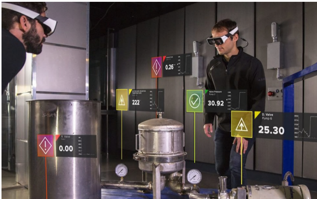
13. ábra Karbantartandó elemek beazonosítása kiterjesztett valóság alkalmazásával (forrás: [63])
